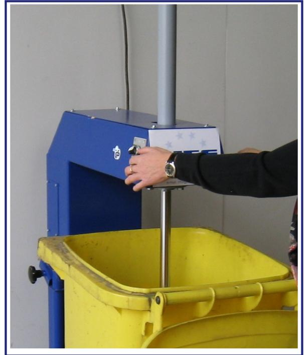
Das Gerät besteht aus einer robusten Stahlkonstruktion, die auch im Freien betrieben werden kann. Der Deckel des 240 Liter MGB wird geöffnet und der Behälter befüllt. Der Behälter wird in das Preßgestell hineingeschoben. Die runde Preßplatte drückt mit ca. 500 dN in den Behälter.
